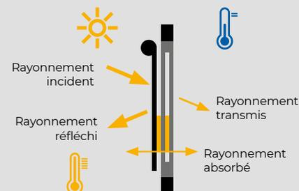
Le facteur solaire  $G_{tot}$  est le rapport entre l'énergie transmise à l'intérieur de la pièce (rayonnement transmis) et l'énergie solaire initiale (rayonnement incident).
